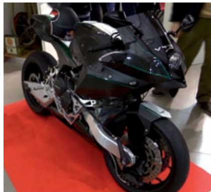
Vyrus 986 M2: Motore Honda 299 cc, 4 cilindri in linea. Peso 135 kg a secco. Potenza 130 CV in versione Factory Moto2. Velocità 290 KmH, Telaio(portante) fatto in composito di varie fibre di carbonio.
